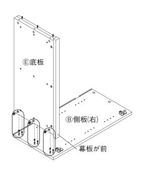
使用するパーツ ⑧側板(右)×1 ⑥底板×1 使用するフィッティングパーツ (a) x 3 (f) X 1
